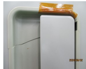
カバー部品のひび割れ
